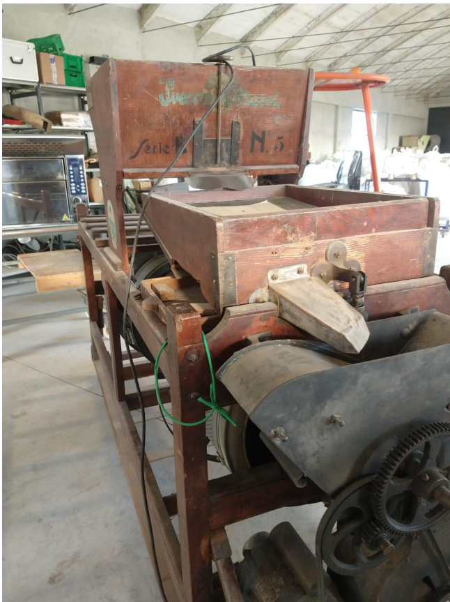
Il svecciatore che serve a pulire dalle impurità il seme e dividerlo per calibro
